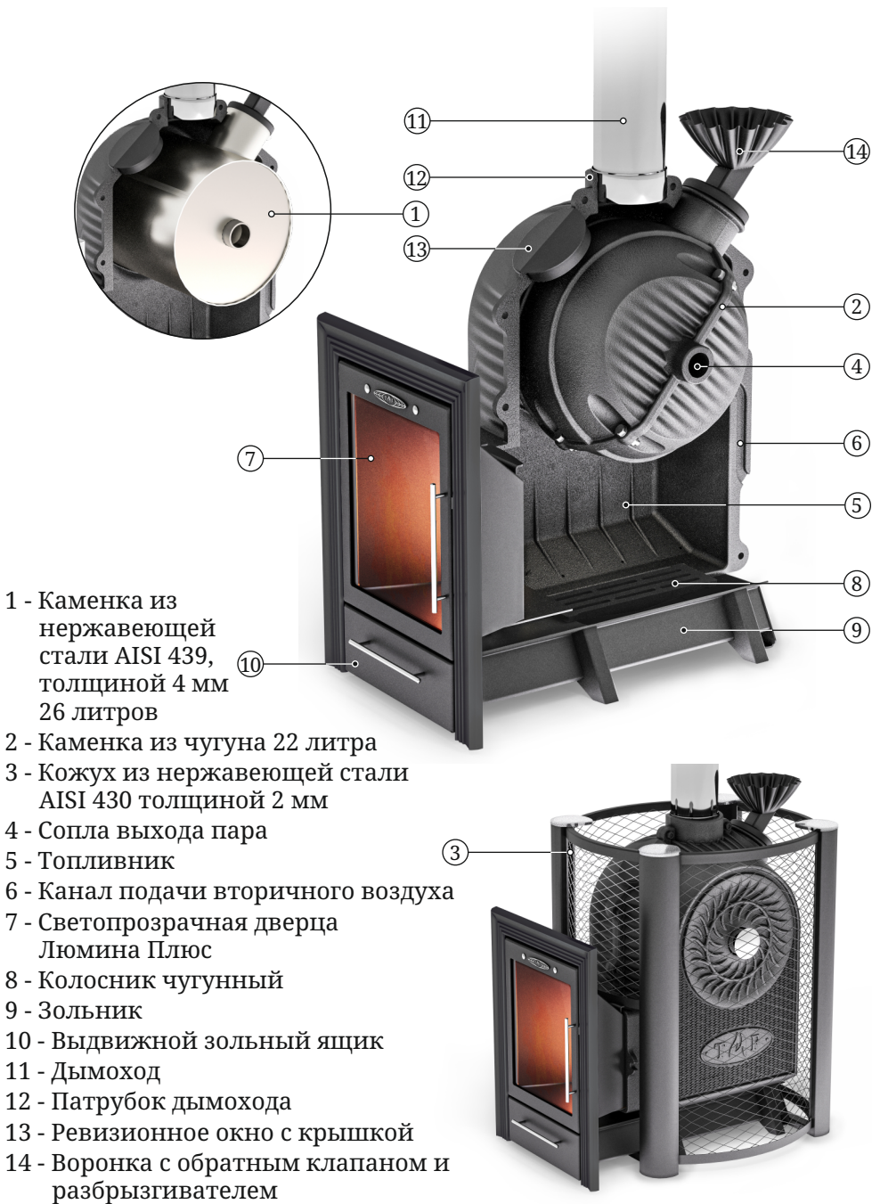
Рисунок 3. Расположение основных элементов чугунной печи «Черная жемчужина»
