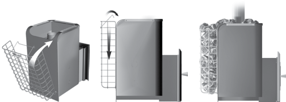
Рисунок -8. Установка сетки-каменки на печь.
