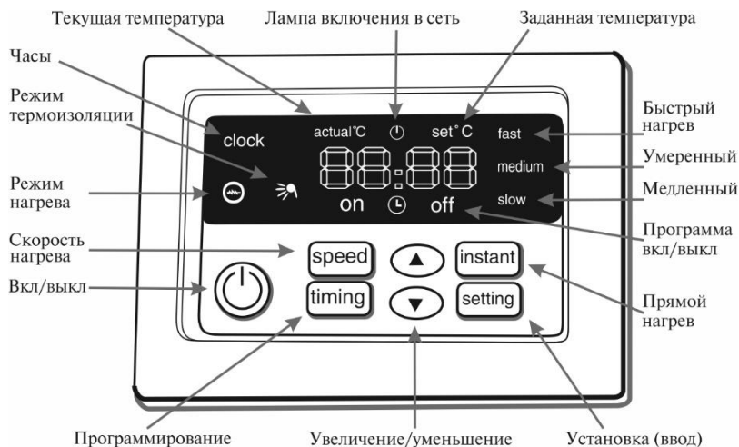
Рисунок 2. Панель блока управления и расположение функциональных кнопок
